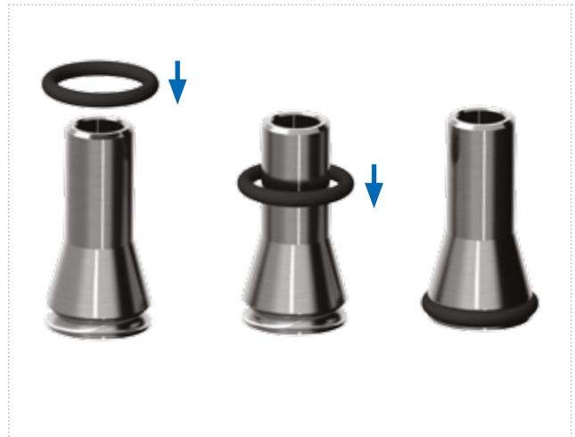
Con el tornillo suministrado atornillar en cada pilar P.A.D. una cánula de titanio para la técnica D.P.F. (cód. PAD-CT-LV), ensamblada en su O-ring negro (cód. PAD-ORING-LV). Meter luego en cada cánula un centrador calcinable (cód. PAD-CC-LV).
