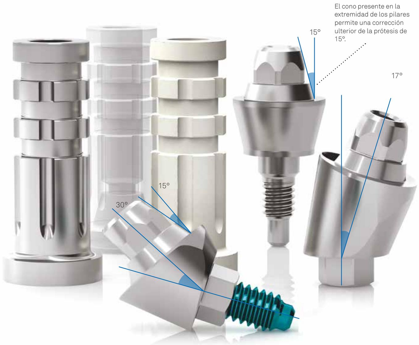
El cono superior permite orientar ulteriormente la estructura protésica de 15° en cada lado; en el caso de los pilares P.A.D. angulados esto se añade a la inclinación de 17° o 30°. Esta característica permite una gestión fácil de los disparelismos hasta 45° en cada lado.
