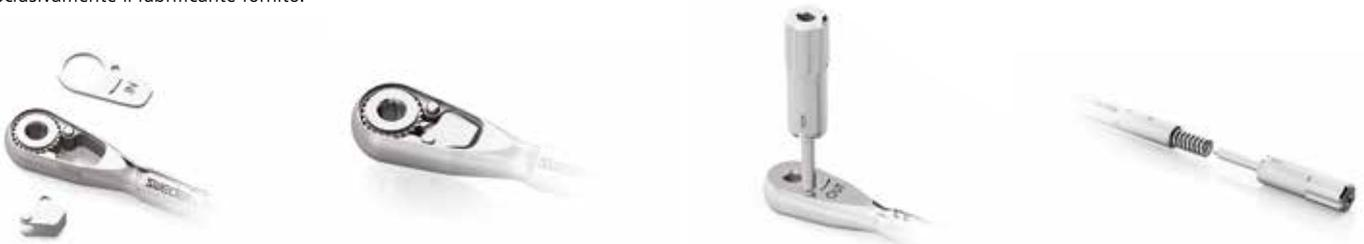
Dopo aver lubrificato le parti indicate in figura, inserire i due elementi che compongono la testa del cricchetto nella seguente sequenza: ruota a nottolino dentellata e successivamente il dente ferma ruota.
