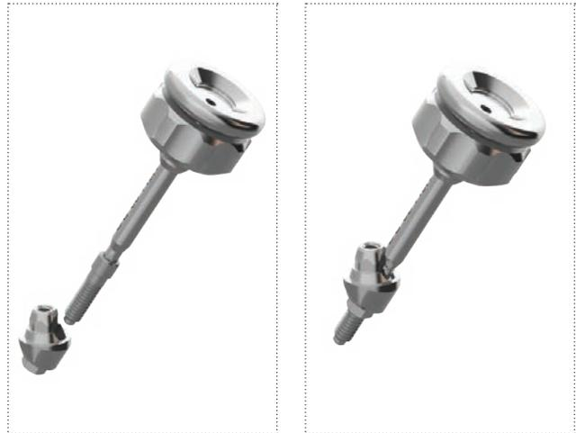
Posizionare l'abutment P.A.D. angolato nella parte inferiore dell'apposito carrier (cod. PAD-CAR) in modo che il foro vite dell'abutment combaci con uno dei due fori laterali del carrier, a seconda dell'orientamento necessario dato dal lato della bocca nel quale si deve intervenire (**img. A**). Inserire nel foro superiore del carrier la vite transfer (cod. PAD-VTRA-140) e serrarla sull'abutment P.A.D. angolato (**img. B**).
