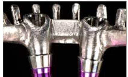
Il framework è composto da barre in titanio preformate unite applicando una cucitura con arco voltaico. Particolare attenzione viene dedicata alle zone critiche in prossimità dei cantilever
