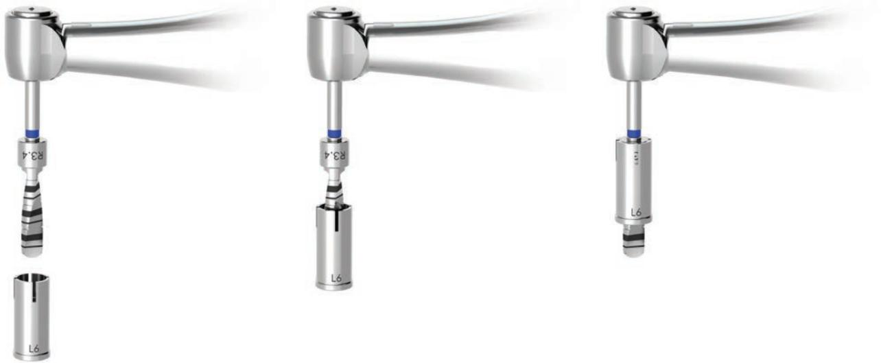
Para retener los toques en la fresa hay 4 aletas en la extremidad de los toques. Para aumentar la interferencia entre los toques y el cuerpo de la fresa, como por ejemplo debido al desgaste provocado por meter y sacar de manera repetida los instrumentos, se deberá ejercer una ligera presión en las aletas desde afuera hacia adentro. Esta simple precaución puede evitar que el tope salga de la fresa durante su empleo.
