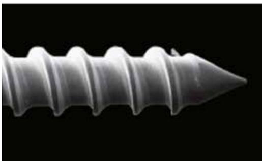
*Punta di una mini vite “non self-drilling” vista al SEM*
