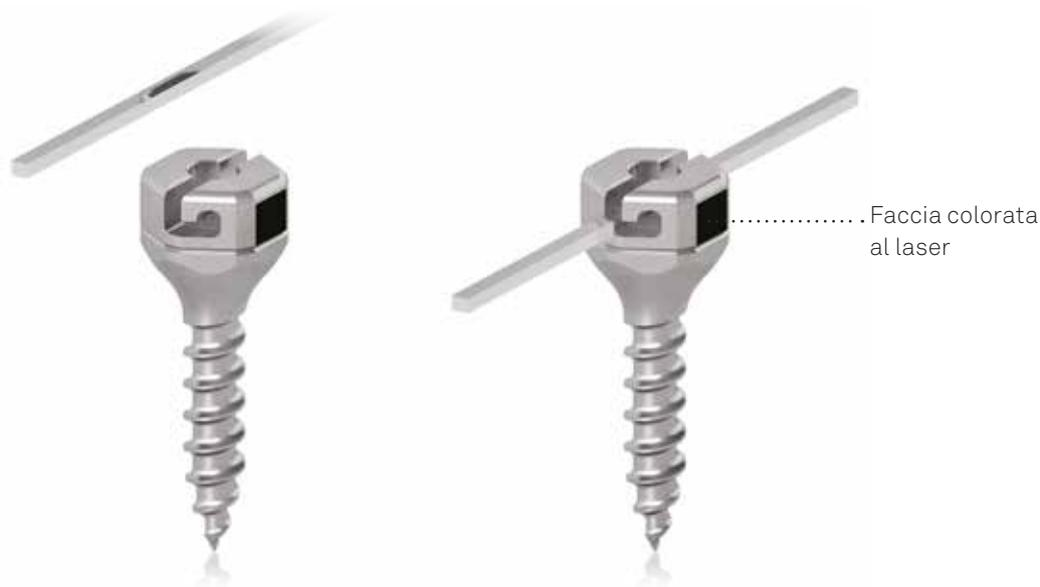
Il pozzetto presente nella testa della mini vite contiene una vitina interna che va ingaggiata mediante l'utilizzo dell'apposito avvitatore. Esercitando quindi un movimento rotatorio in senso orario, quindi concorde al verso di inserimento della mini vite, la vitina interna fuoriesce andando a comprimere e quindi a bloccare il filo.
