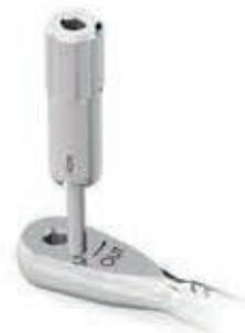
Lubricar el resorte dentro del mango de la carraca, tal y como está mostrado en la figura. Ensamblar el tornillo de regulación del torque comprobando la correcta funcionalidad del instrumento y activando manualmente la rueda de trinquete.
