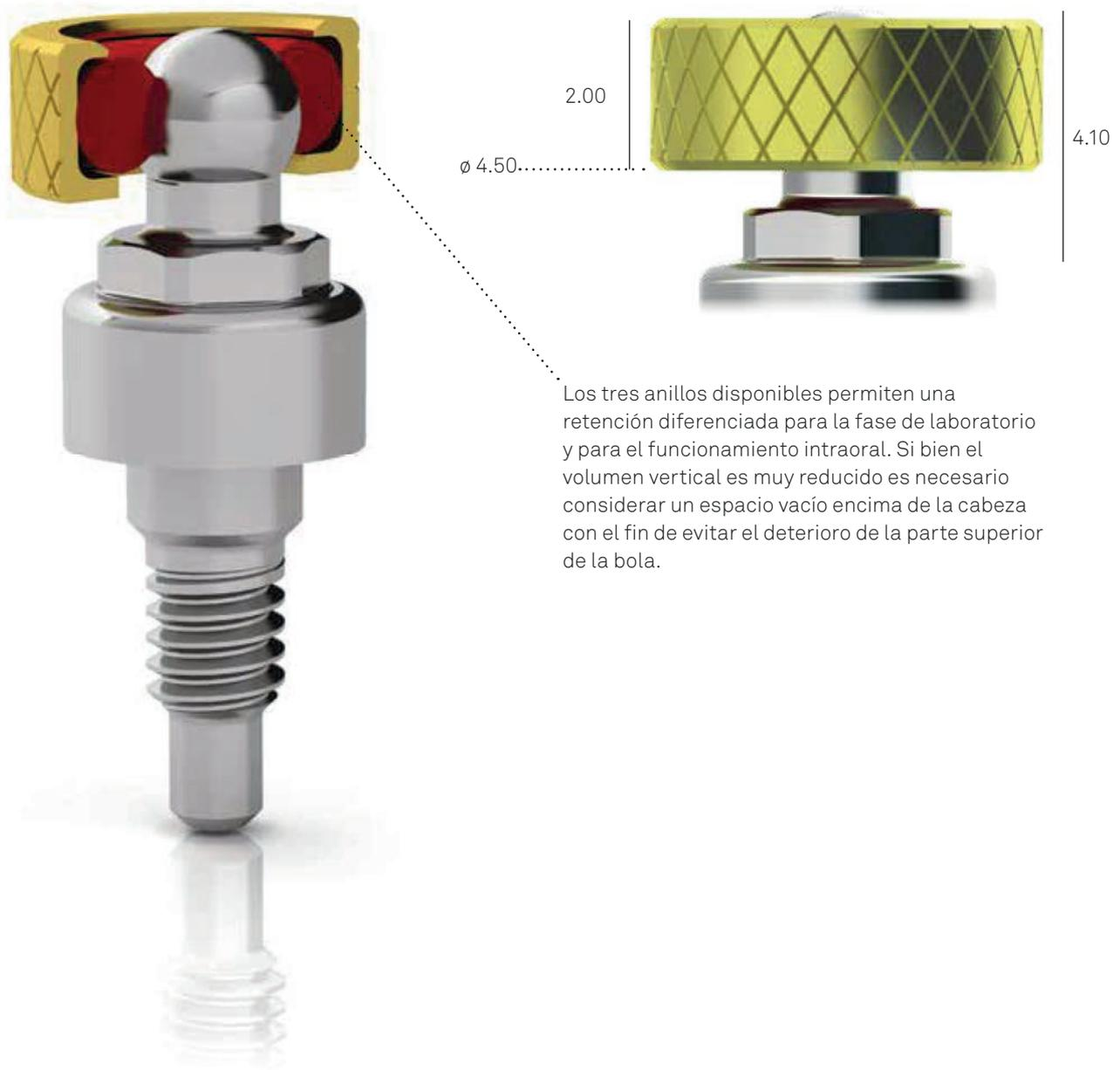
Los tres anillos disponibles permiten una retención diferenciada para la fase de laboratorio y para el funcionamiento intraoral. Si bien el volumen vertical es muy reducido es necesario considerar un espacio vacío encima de la cabeza con el fin de evitar el deterioro de la parte superior de la bola.
