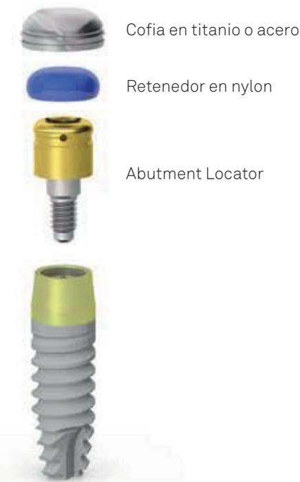
El sistema Locator dispone de una práctica cofia en acero sobre la que se aloja el retenedor dentro de la prótesis. Cuando el retenedor pierde su capacidad de retención, la sustitución es muy fácil, ya que no es necesario extraerlo de la resina quitando material a la prótesis, sino que con una sencilla operación se puede extraer de la cofia en metal, la cual queda fijada a la prótesis.
