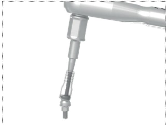
Atornillar la estructura en la boca del paciente respetando un torque de 20-25 Ncm y cerrar el agujero del tornillo con resina o composite.
