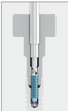
**Figura 3.** Fresa a spirale, con relativa guida, a contatto con la vite rotta
