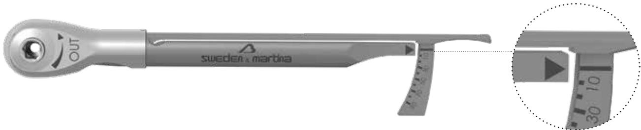
Es posible usar la carraca dinamométrica como llave fija, es decir, sin usar la escala dinamométrica haciendo palanca en todo el mango. En este caso les aconsejamos no someterla a una carga superior de 150 Ncm.
