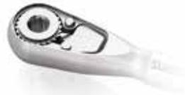
Una vez introducidas y lubricadas las partes 2 y 3 en la cabeza del cuerpo de la carraca, colocar la tapa y girar el cuerpo de la carraca desde el lado OUT. Apretar el tornillo con la punta hexagonal del tornillo de regulación del torque.
