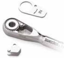
Lubricar las zonas de contacto entre el diente de la rueda de trinquete y el poste del diente de sujeción de rueda.
