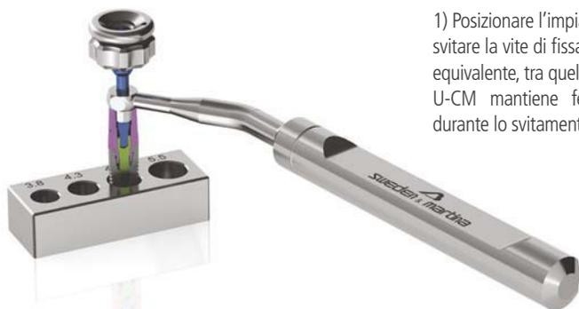
1) Posizionare l'impianto nell'U-SUP con una pinzetta sterile; svitare la vite di fissaggio con HSM-20-DG o altro avvitatore equivalente, tra quelli a pag. 27. La chiavetta ferma mounter U-CM mantiene fermo il complesso impianto-mounter durante lo svitamento della vite.
