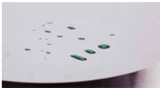
Sobre un disco de titanio limpiado pero sin tratamiento al plasma se echa una solución apropiada para evaluar la bañabilidad. El líquido se adensa en gotas (pruebas de laboratorio).
