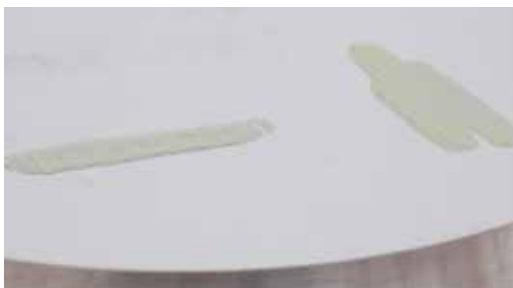
Después del tratamiento con Plasma R el líquido mantiene la forma aplastada y tiende a propagarse en la superficie (pruebas de laboratorio).
