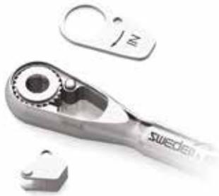
Dopo aver lubrificato le parti indicate in figura, inserire i due elementi che compongono la testa del cricchetto nella seguente sequenza: ruota a nottolino dentellata e successivamente il dente ferma ruota.
