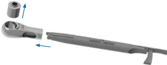
Premere l'avvitatore ed estrarlo dalla testa della chiave, quindi rimuovere la testa premendo nell'incavo, estraendola con delicatezza. Le tre parti separate sono pronte per la pulizia.
