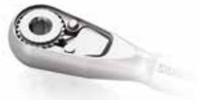
Lubrificare le zone di contatto tra il dente della ruota a nottolino ed il perno del dente ferma ruota.
