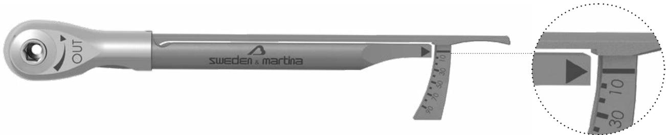
È possibile utilizzare la chiave dinamometrica come chiave fissa ovvero senza usare la scala dinamometrica facendo leva sull'intero manico, in tal caso si raccomanda di non sottoporla a un carico superiore ai 150 Ncm.
