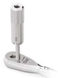
Lubrificare la molla all'interno del manico del cricchetto come mostrato in figura. Assemblare la vite di regolazione del torque verificandone la corretta funzionalità dello strumento ed attivando manualmente la ruota a nottolino.
