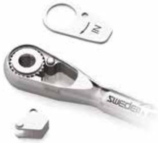
Después de haber lubricado las partes indicadas en la figura, introducir los dos elementos que componen la cabeza de la carraca según el siguiente orden: rueda de trinquete dentada y luego el diente de sujeción de rueda.
