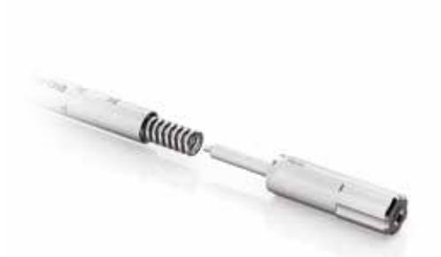
Lubricar el resorte dentro del mango de la carraca, tal y como mostrado en la figura. Ensamblar el tornillo de regulación del torque comprobando la funcionalidad correcta del instrumento y activando manualmente la rueda de trinquete.
