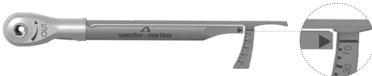
Después de su esterilización y antes de su empleo, asegúrese de que la primera marca en la escala esté alineada con la flecha. Antes de emplear la carraca, se deberá comprobar su montaje correcto y su funcionamiento.
