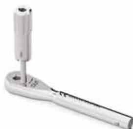
Con la punta hexagonal ubicada en la base del tornillo de regulación del torque, desatornillar y quitar totalmente el tornillo de fijación de la tapa del lado indicado con OUT. Ejercer una ligera presión para evitar dañar la punta hexagonal.
