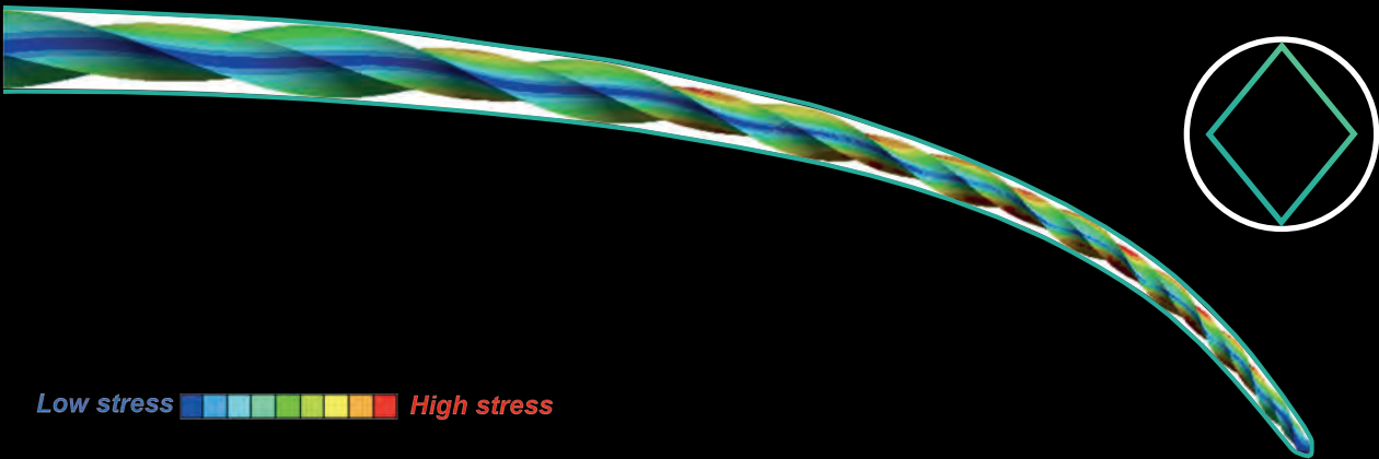
Modellazione virtuale: analisi virtuale dinamica della fatica ciclica per B-4U.
