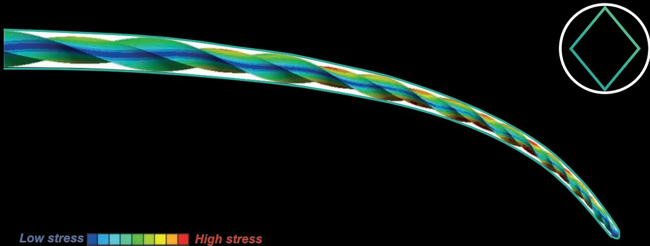
Modelado virtual: análisis dinámico virtual de fatiga cíclica para B-4U.
